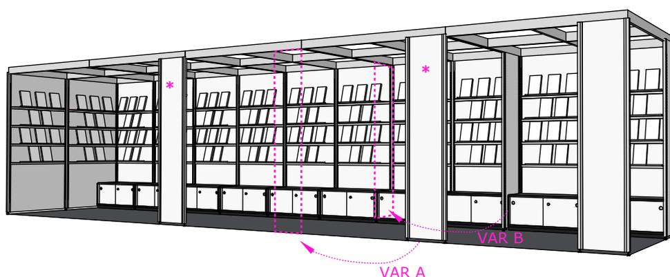
Weitere Standardvarianten sind möglich, analog zu den 16 qm (2 m x 8 m) Eckstand Varianten. Zu beachten ist lediglich, dass gangseitig alle 4 m und an der Rückwand alle 8 m aus statischen Gründen eine Stützwand platziert werden muss.
