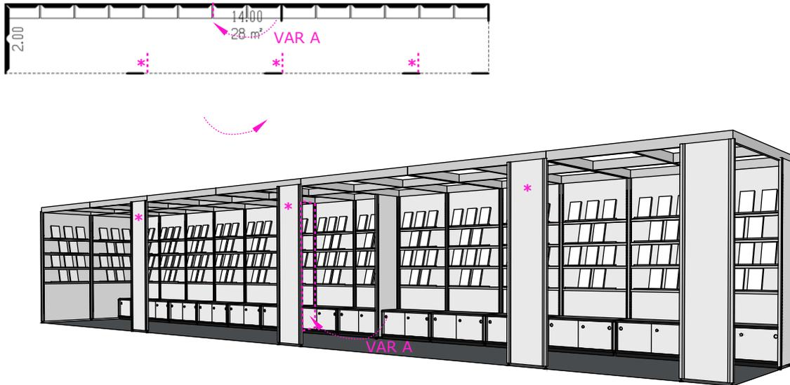
Weitere Standardvarianten sind möglich, analog zu den 16 qm (2 m x 8 m) Eckstand Varianten. Zu beachten ist lediglich, dass gangseitig alle 4 m und an der Rückwand alle 8 m aus statischen Gründen eine Stützwand platziert werden muss.
